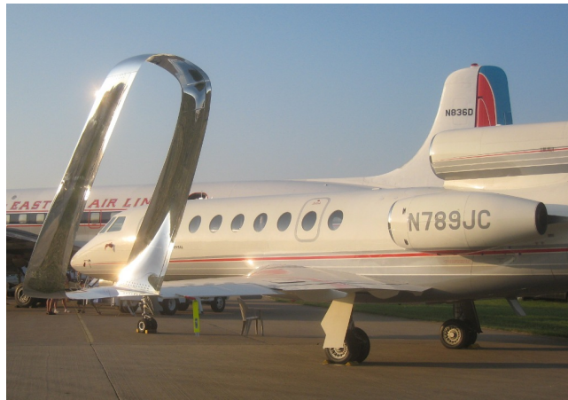
FIGURE 5.3 – Exemple de modification du bout d’aile pour réduire la traînée induite : winglet en forme spiroïdale sur un Falcon 50 d’après wikimedia commons .
