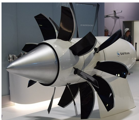
FIGURE 5.1 – Soufflante non carénée présentée au salon du Bourget 2017 au stand de Safran d’après wikimedia commons .
